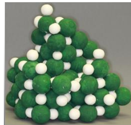
Abb.1: Ionengitter von Natriumchlorid, in alle Raumrichtungen erweitert.
