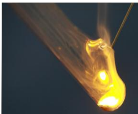
Abb.7: Microscale-Variante der Reaktion von Natrium mit Chlor [18, OE9]
