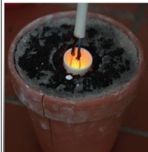
Abb.5: Nachweis der elektrischen Leitfähigkeit einer Natriumchlorid-Schmelze [18]
